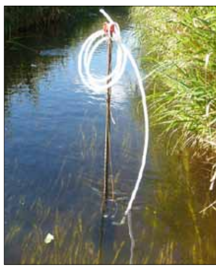
Figur 2. SorbiCeller med monteret klar til placering i vandløb (venstre) og billede af systemet fastgjort til nedrammet pæl (højre).
