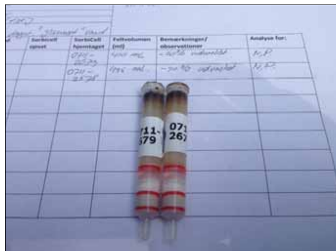
Figur 1. Funktionsprincippet for en SorbiCell (venstre) og billede af to SorbiCell prøvetagere efter eksponering (højre).
